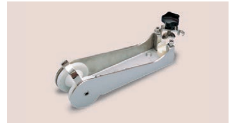
Musone in acciaio inox AISI 316 lucidati a specchio lungh. 330 largh. 80 sp. 4 mm con 1 bloccaggio. Polished stainless steel AISI 316 bow roller length 330 width 80 thickness 4 mm with bloking device. Per ancore Bruce/ Danforth fino a 10 Kg For anchors Bruce/ Danforth up to 10 Kg Cod. 229.06 Cod. 229.06
