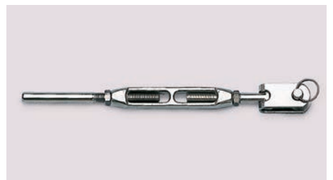
Tenditori acc. inox con canala aperta - forcella a snodo incorporato e terminale cilindrico a pressare.
